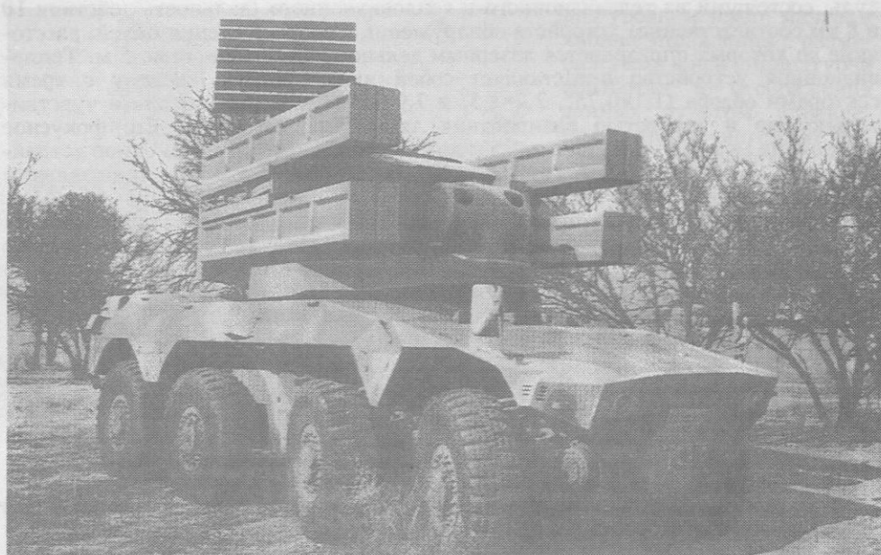
Рис. 2. Внешний вид южноафриканского мобильного зенитного ракетного комплекса ближнего действия SPAAM
